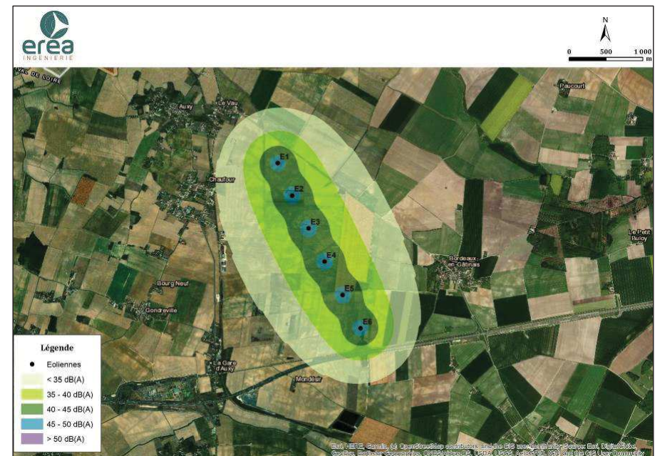
Figure 192 : Isophones pour l'implantation de 6 éoliennes de modèle E126 pour un vent de vitesse standardisée de 5 m/s (Source : Etude acoustique d'EREA Ingénierie)
